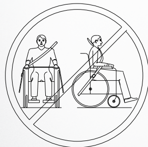
Abb. 34: Abbildung eines unsachgemäßen Gurtsystems
