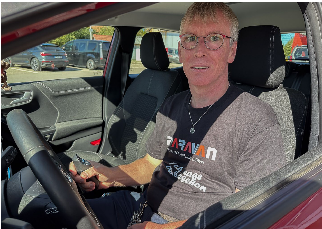
Stefan ist wieder mobil, ein Leben ohne Auto konnte er sich nicht vorstellen. Dank Automatikgetriebe und dem Multifunktionsdrehknopf MultiMote kann er sein Fahrzeug nun nur mit dem linken Bein und der Linken Hand bedienen. Foto: PARAVAN
