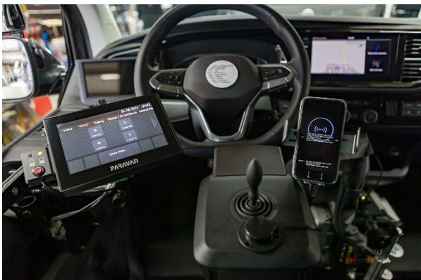
Es sieht schon ein bisschen aus, wie im Flugzeug, das Space Drive Cockpit von Bruno. Der Joystick ist analog zum Rollstuhl mittig angeordnet. Neben dem PARAVAN Touch für die Sekundärfunktion gibt es noch zusätzliche Monitore für das Kamerasystem mit Umfelderkennung. Denn Bruno kann sein Kopf nicht so einfach drehen. Foto: PARAVAN
