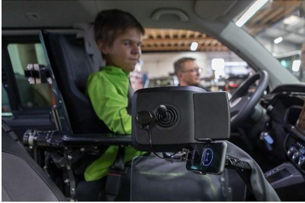
Bevor es losgeht, fährt der 4-Wege-Joystick, mit dem er Dank des Drive-by-Wire-Systems Space Drive sein Fahrzeug steuert, an den gewünschten Platz. Eine Rückenstütze sorgt für den nötigen sicheren Halt im Rollstuhl. Foto: PARAVAN
