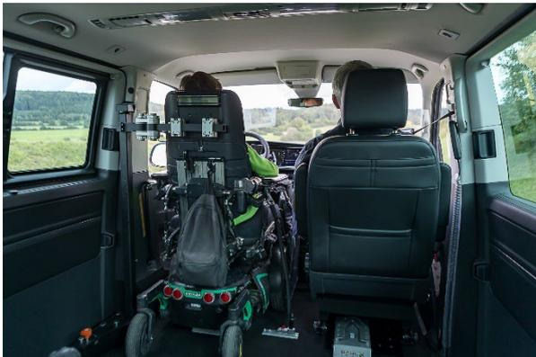
Letzt Checkfahrt mit Fahrlehrer Horst Hilsenbeck. Jetzt werden alle Einstellungen noch einmal geprüft: ist ein ermüdungsfreies Fahren gewährleistet, passen die Verankerungen und die Rückenstütze für den zusätzlichen Halt im Rollstuhl? Foto: PARAVAN
