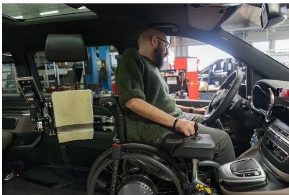
Mit seinem Rollstuhl fährt Benjamin direkt vor das Lenkrad. Verankert ist er mit EZ-Look, einem flexiblen Sicherungssystem für Aktivrollstühle. Die PARAVAN Kopf- und Rückenstütze fährt im Anschluss in die optimale Position und sorgt für zusätzlichen Halt. FOTO: PARAVAN
