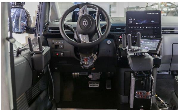
*Mathias Cockpit ist futuristisch: Ein modernes Fahrzeug-Design mit vielen Möglichkeiten und individuell angepasste Eingabegeräte. Mit dem Gas-Brems-Schieber links beschleunigt er das Fahrzeug oder bremst. Das Minilenkrad auf der rechten Seite nutzt er zum Lenken.*
