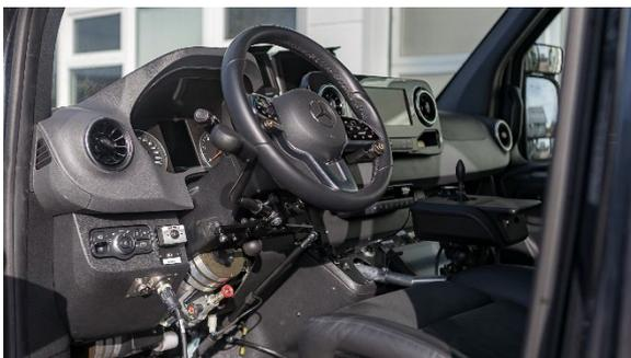
*Der Mercedes Sprinter der PARAVAN-Fahrschule bietet viele Möglichkeiten und ist je nach Bedarf sehr schnell umgerüstet, vom einfachen mechanischen Handbediengerät bis zum elektronischen Fahr- und Lenksystem Space Drive. Foto: PARAVAN*
