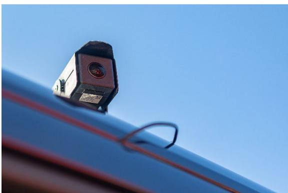
*Ein hochauflösendes Kamerasystem, je nach Bedarf am Auto positioniert sorgt für den perfekten Rundumblick. Monitore mit der erforderlichen Umfelderkennung im Fahrzeug geben das Bild weiter und zeigen an, wie weit Personen und Gegenstände vom Auto entfernt sind, und ob sie sich bewegen. Foto: PARAVAN*
